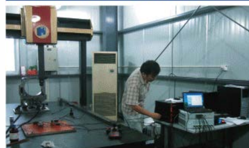
三坐标测量机隔振壕及隔振支座试验
