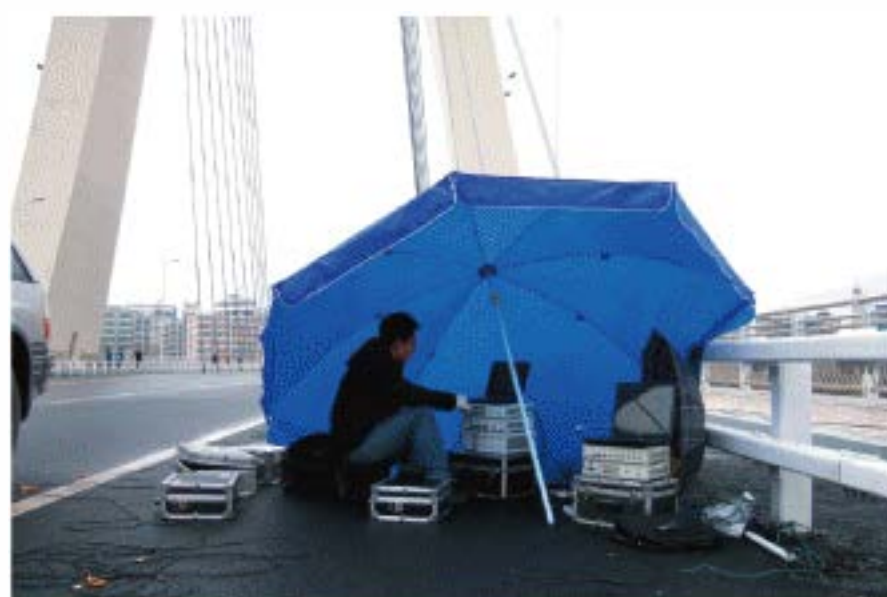
桥梁竣工模态试验
