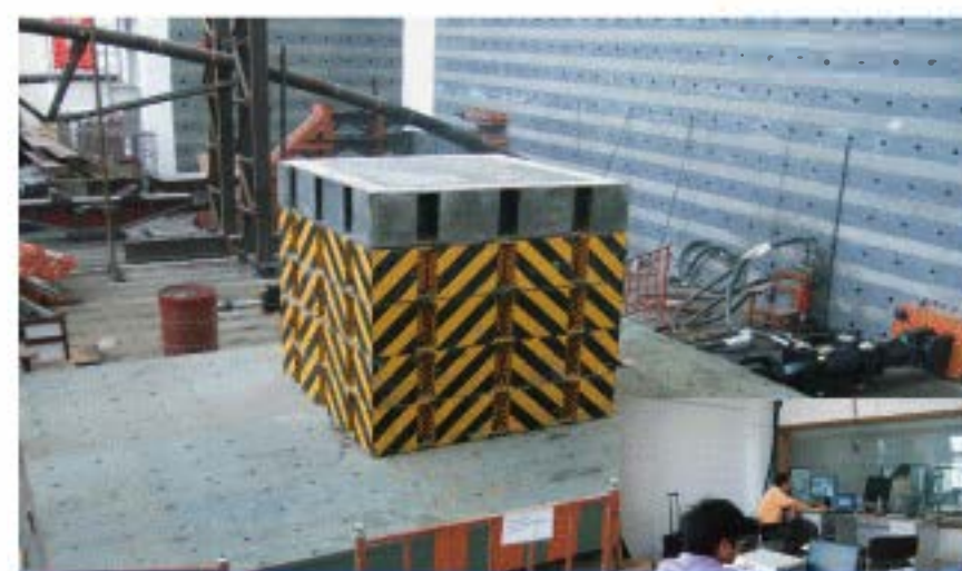
大型液压试验台模拟地震环境试验
