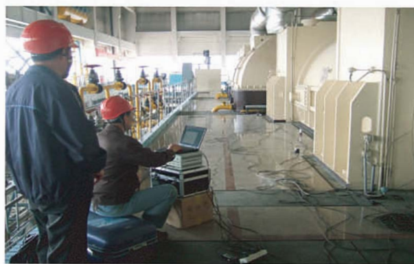
徐州电厂发电机楼板振动工况模态试验 (2008年11月15日)
